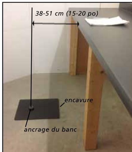
Positionnez la plaque de métal au sol avec l'encavure du côté de la surface de travail. L'ancrage du banc sera à une distance de 38 à 51 cm, selon la taille de l'utilisateur.
